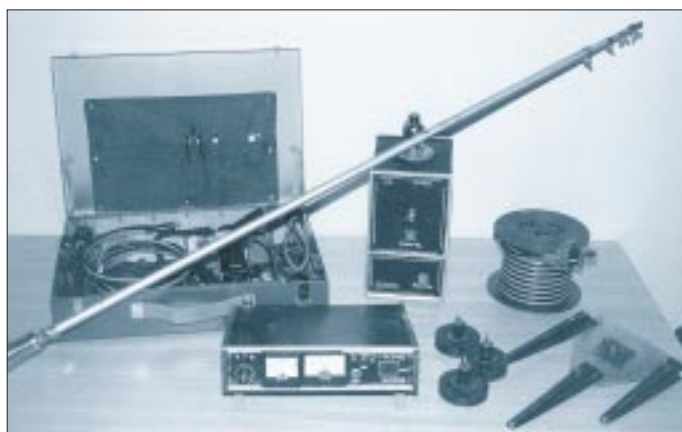
Bild 1: Die Antenne und das gesamte Zusatz-Equipment. Ein Meßgerät am SWR-Meter/Steuergerät zeigt übrigens den Strom im Antennenkabel an, was sich als sehr hilfreich beim Abstimmen erwies.
