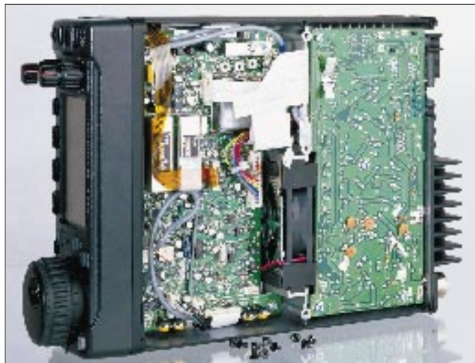
Auf der unteren Seite finden sich auch eine Reihe von Abschirmboxen. Links unten die Senderendstufe Fotos: N. Schiffhauer, DK8OK
