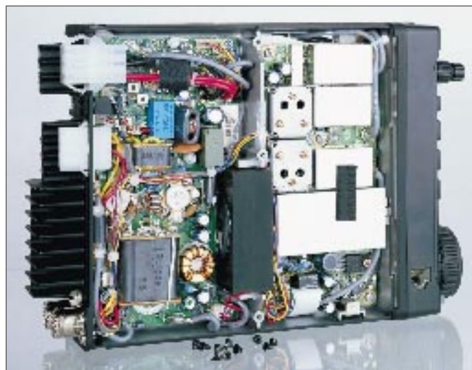
Auf der unteren Seite finden sich auch eine Reihe von Abschirmboxen. Links unten die Senderendstufe Fotos: N. Schiffhauer, DK8OK
